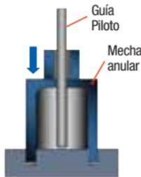
**2** La mecha anular perfora un anillo sobre el material y la guía piloto permanece sobre el mismo sin perforar
