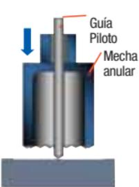
**1** La guía piloto se sienta sobre el material y la mecha se acerca hasta el inicio de la perforación.
